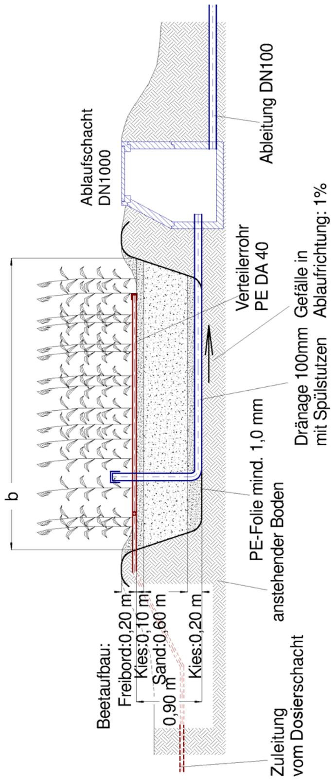
Kleinkläranlagen: bepflanzte Bodenfilter (Pflanzenbeete) nach Mehrkammergruben
