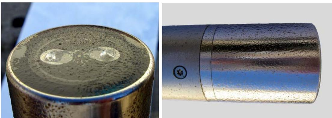
Bild 8.4 Leichte Verschmutzungen nach fünf Tagen bei einer Anlage mit geringen Ablaufwerten und Schlammanteilen in der Nachklärung (Tropfkörper 2)
