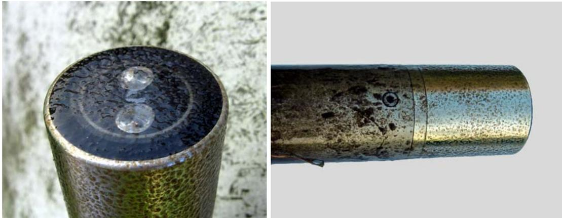
Bild 8.3 Anlagerungen am Sensor bei stark verschmutztem Ablauf nach drei Tagen (Tropfkörper 1)
